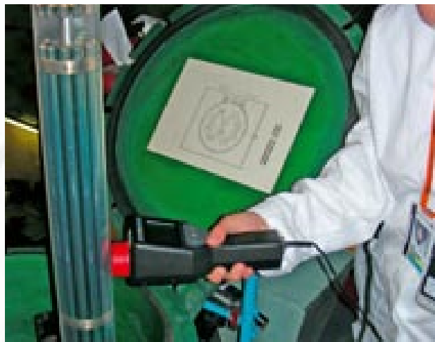
1 pav. Nenaudoto kuro kasetės patikrinimas neardomosios analizės būdu.
