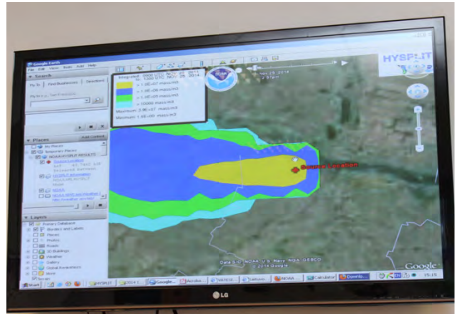
Radionuklidų pernašos prognozė pratybų metu Dispersion prognosis of released radioactive material during exercise
