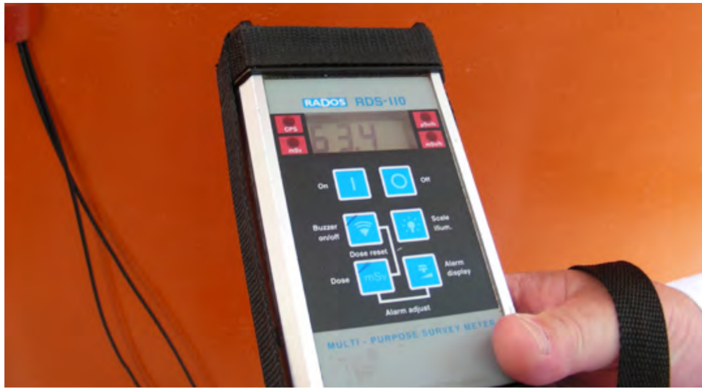
Dozės galios matavimai konteinerio paviršiuje Dose rate measurement on surface of container
