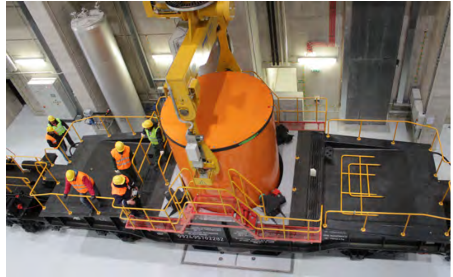
Konteinerio dėjimas ant vežimo platformos Placement of container on transporter
